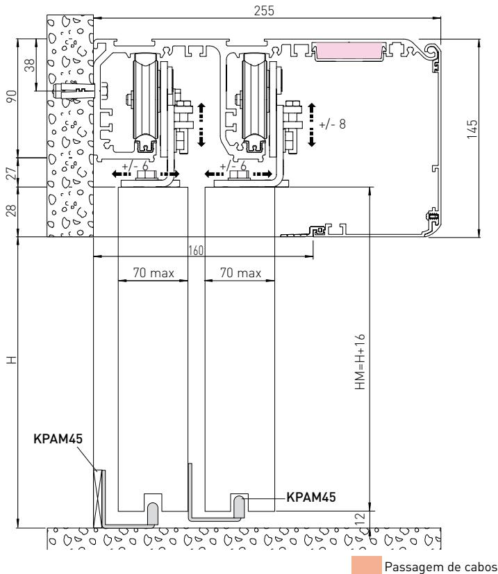
Na figura, encontram-se indicadas as medidas de fixação à parede do automatismo VALOR T, considerando que as portinholas da porta são realizadas mediante perfis não fabricados por nós. Caso as portinholas sejam realizadas com os perfis DITEC da série: PAM fazer referência às medidas indicadas nos relativos manuais.
