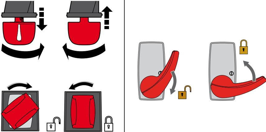
Nos casos de manutenção, mau funcionamento, ou de emergência, puxar para baixo e girar para a direita a alavanca de desbloqueio VALSB ou baixar a alavanca de desbloqueio LOKSB (se instalada) e deslocar manualmente as portinholas para a posição de abertura.
